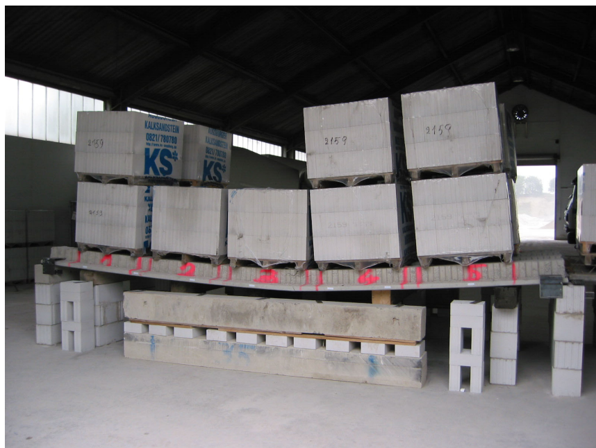
Bild 4.124: Versuchseinrichtung für Stegverbundplatten gemäß [4.11]
