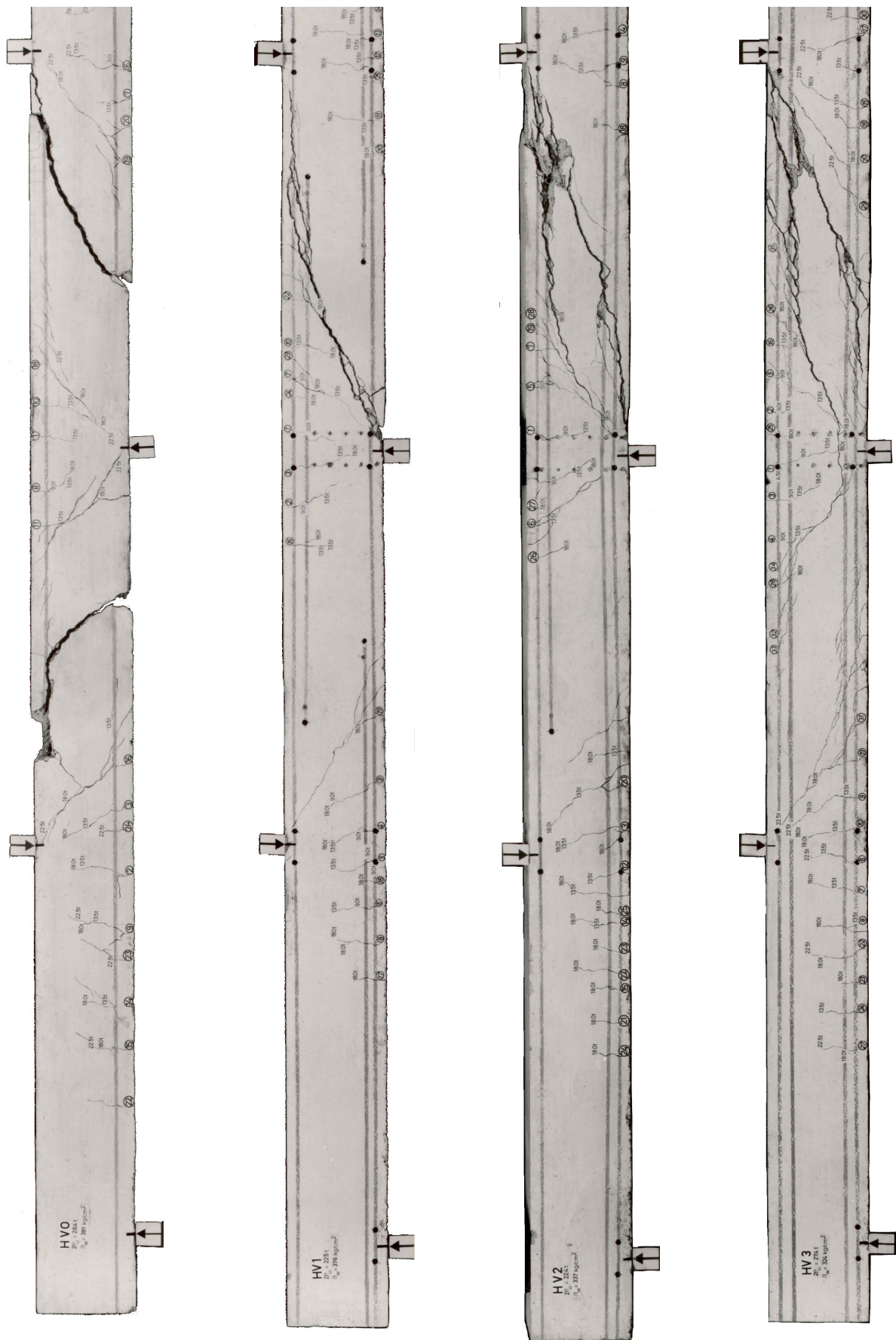
Bild 4.33: Rissbilder der Balken HV 0 bis HV 3 aus [2.7] (ausschnittsweise)
