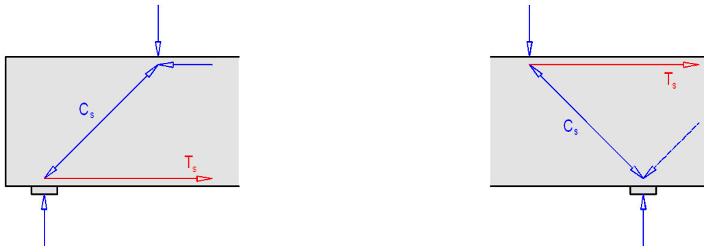
Bild 4.55: Kraftfluss bei D_{e1} -Bereichen und D_{i1} -Bereichen
