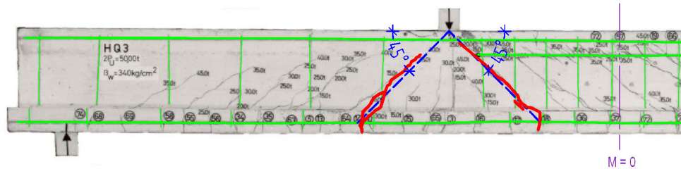
Bild A.4.68: Risse im Kräfteinleitungsbereich des Balkens HQ 3 (linker Teil) mit radialen Abschnitten
